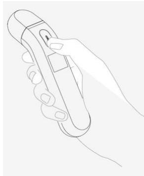
③ El indicador acústico emitirá un pitido una vez que se obtenga la lectura (la función del interruptor del indicador acústico es opcional, consulte “(4) Interruptor del indicador acústico” para conocer los ajustes). La lectura se mostrará en la pantalla. Si la medición falla, el indicador acústico no sonará y la pantalla mostrará [ - - - °C ] en su lugar.
